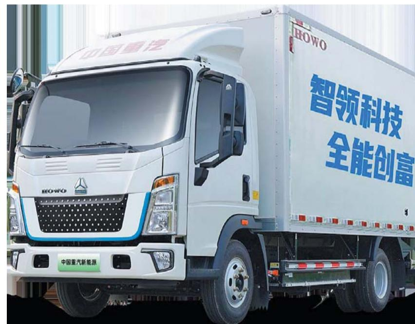
理，中国重汽 HOWO 新能源轻卡综合电耗降低 8%，实测中，中国重汽 HOWO 132 度新能源轻卡在满载情况下，其 SOC 电量从 100%-0 续航里程可达 367.42 公里，百公里能耗约为 35.91kWh，真正实现不止依赖大容量电池、更通过高效低耗的能源策略实
