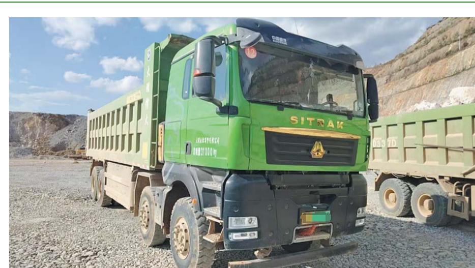
面临严峻考验。在此如此极端工况下，汕德卡纯电自卸车展现出非凡的可靠性与承载力。其采用 8+8+8/316 三层车架结构设计，铸造飞机梁横梁，不仅像“钢筋铁骨”一样耐磨抗造，其承载能力更是大幅提升；匹配曼技术 28T 车桥，轮边减速加宽制动，即使雨天
