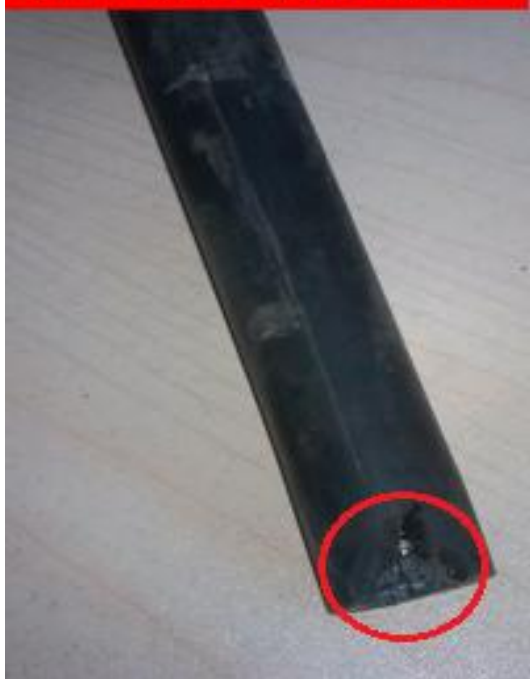
损坏 1: 胶套底端击穿损坏
